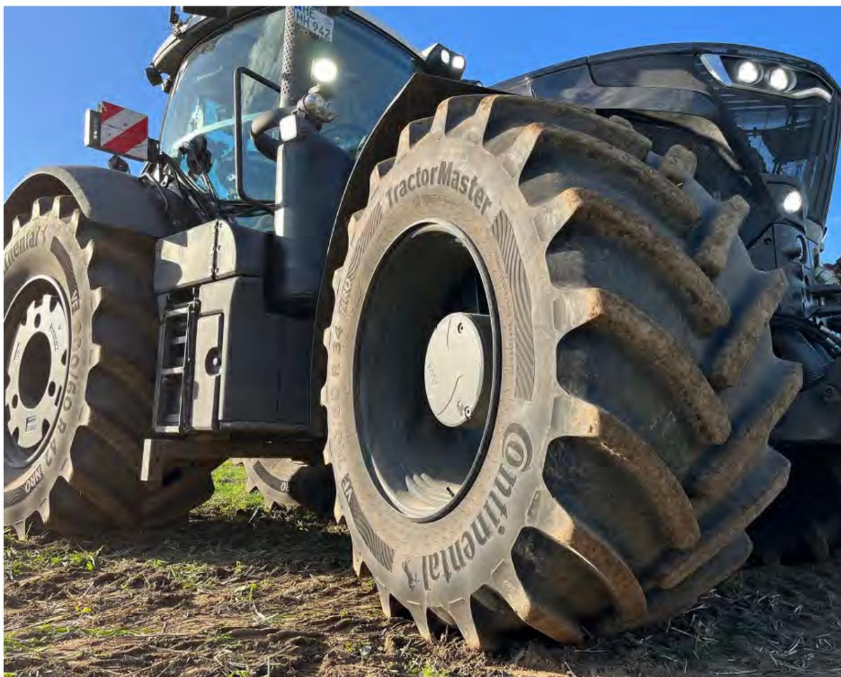
Continental ha lanzado su neumático para tractores más grande hasta la fecha, el VF TractorMaster, con dimensiones VF900/60R42. Con un diámetro de 2.147 milímetros, el neumático es más grande que el marco de una puerta y pesa 475 kilogramos con un índice de carga de 189 (10.300 kg). Estas dimensiones está diseñadas específicamente para que el neumático soporte el peso de maquinaria agrícola con más de 300 caballos de potencia.
